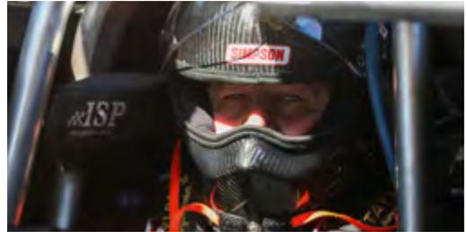
Integrales Helmsystem mit Vollvisier, Filtern und Schauerstoff-Notversorgung (blauer Schlauch).
